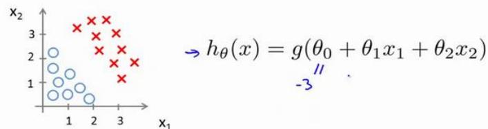
并且参数 $\theta$  是向量 $[-3 \ 1 \ 1]$ 。则当 $-3 + x_1 + x_2 \geq 0$ ，即 $x_1 + x_2 \geq 3$ 时，模型将预测  $y = 1$ 。我们可以绘制直线 $x_1 + x_2 = 3$ ，这条线便是我们模型的分界线，将预测为 1 的区域和预测为 0 的区域分隔开。
