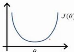
正规方程是通过求解下面的方程来找出使得代价函数最小的参数的:  $\frac{\partial}{\partial \theta_j} J(\theta_j) = 0$ 。
