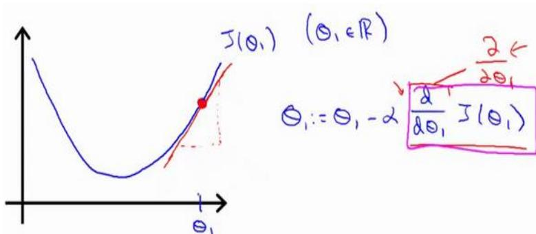
对于这个问题，求导的目的，基本上可以说取这个红点的切线，就是这样一条红色的直线，刚好与函数相切于这一点，让我们看看这条红色直线的斜率，就是这条刚好与函数曲线相切的这条直线，这条直线的斜率正好是这个三角形的高度除以这个水平长度，现在，这条线有一个正斜率，也就是说它有正导数，因此，我得到的新的 $\theta_1$ ， $\theta_1$ 更新后等于 $\theta_1$ 减去一个正数乘以 $\alpha$ 。
