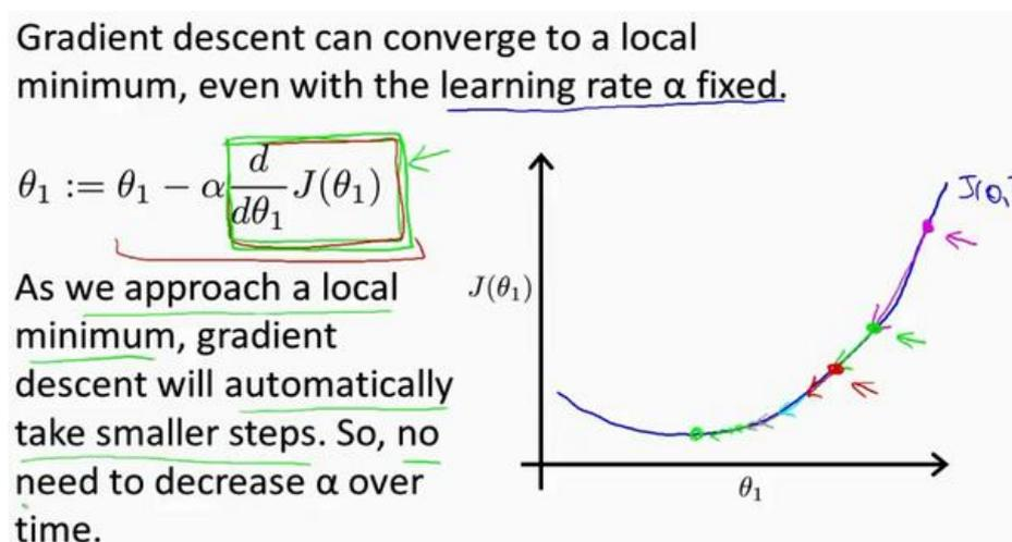
我想找到它的最小值，首先初始化我的梯度下降算法，在那个品红色的点初始化，如果我更新一步梯度下降，也许它会带我到这个点，因为这个点的导数是相当陡的。现在，在这个绿色的点，如果我再更新一步，你会发现我的导数，也即斜率，是没那么陡的。随着我接近最低点，我的导数越来越接近零，所以，梯度下降一步后，新的导数会变小一点点。然后我想再梯度下降一步，在这个绿点，我自然会用一个稍微跟刚才在那个品红点时比，再小一点的一步，到了新的红色点，更接近全局最低点了，因此这点的导数会比在绿点时更小。所以，我再进行一步梯度下降时，我的导数项是更小的， $\theta_1$ 更新的幅度就会更小。所以随着梯度下降法的运行，你移动的幅度会自动变得越来越小，直到最终移动幅度非常小，你会发现，已经收敛到局部极小值。
