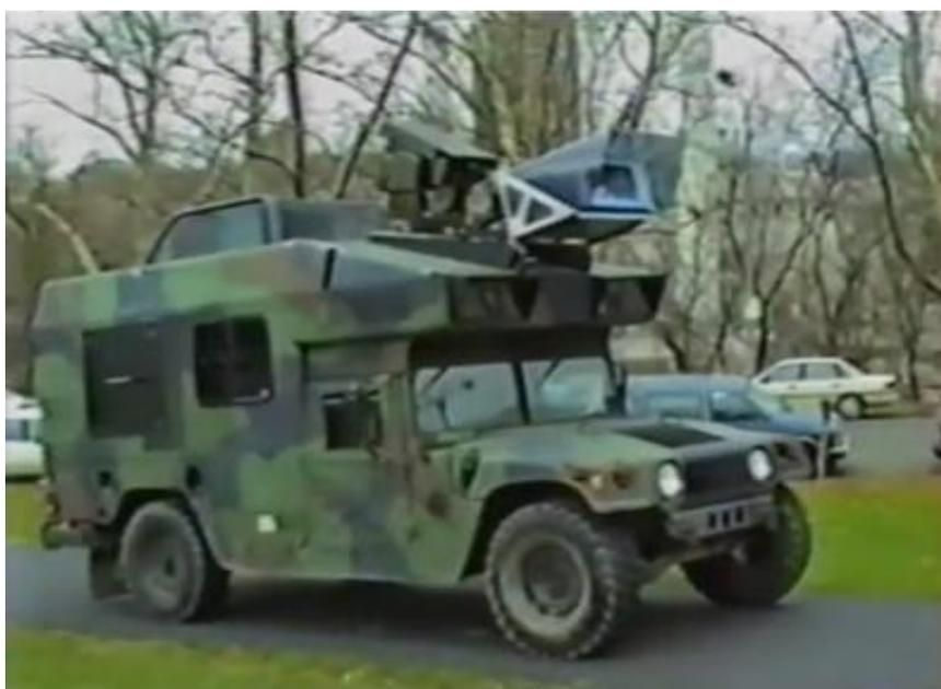
**ALVINN (Autonomous Land Vehicle In a Neural Network)**是一个基于神经网络的智能系统，通过观察人类的驾驶来学习驾驶，**ALVINN**能够控制 **NavLab**，装在一辆改装版军用悍马，这辆悍马装载了传感器、计算机和驱动器用来进行自动驾驶的导航试验。实现 **ALVINN** 功能的第一步，是对它进行训练，也就是训练一个人驾驶汽车。
