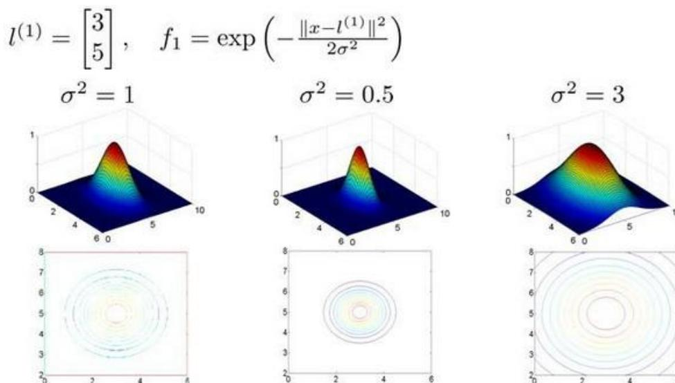
图中水平面的坐标为  $x_1, x_2$  而垂直坐标轴代表  $f$ 。可以看出，只有当  $x$  与  $l^{(1)}$  重合时  $f$  才具有最大值。随着  $x$  的改变  $f$  值改变的速率受到  $\sigma^2$  的控制。
