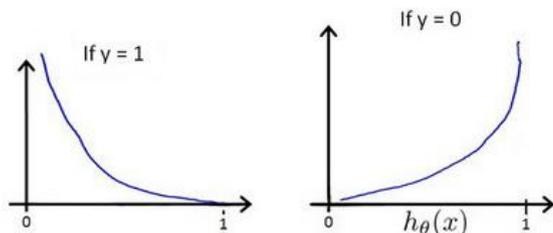
这样构建的 $Cost(h_{\theta}(x), y)$ 函数的特点是：当实际的  $y = 1$  且 $h_{\theta}(x)$ 也为 1 时误差为 0，当  $y = 1$  但 $h_{\theta}(x)$ 不为 1 时误差随着 $h_{\theta}(x)$ 变小而变大；当实际的  $y = 0$  且 $h_{\theta}(x)$ 也为 0 时代价为 0，当 $y = 0$  但 $h_{\theta}(x)$ 不为 0 时误差随着  $h_{\theta}(x)$ 的变大而变大。
