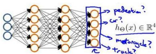
Want  $h_{\theta}(x) \approx \begin{bmatrix} 1 \\ 0 \\ 0 \\ 0 \end{bmatrix}$ ,  $h_{\theta}(x) \approx \begin{bmatrix} 0 \\ 1 \\ 0 \\ 0 \end{bmatrix}$ ,  $h_{\theta}(x) \approx \begin{bmatrix} 0 \\ 0 \\ 1 \\ 0 \end{bmatrix}$ , etc.
